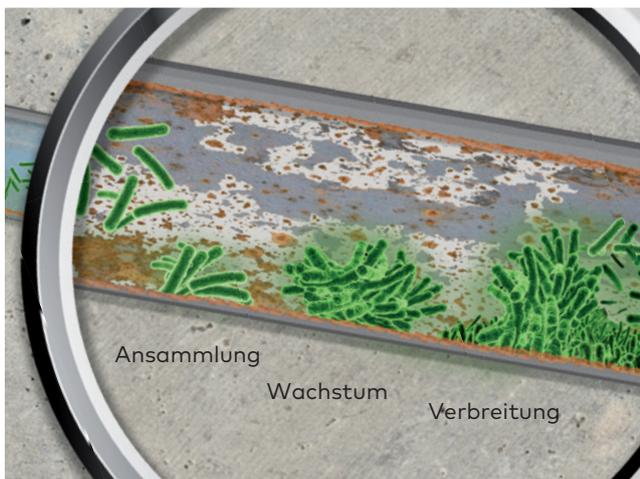
Wachstum von Keimen im Trinkwassersystem
